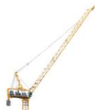
Cat. 2 : Grue à tour à montage par éléments, à flèche relevable – Conduite cabine
