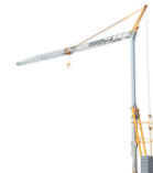
Cat. 3 : Grue à tour à montage automatisé – Conduite au moyen d'une télécommande
